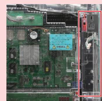
払出ユニットを取り外した状態
