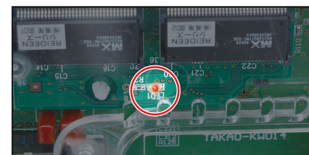
演出制御基板(LED1個が点灯) ※機種によって場所などが異なります。
